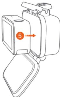
Introduzca Mi Action Camera 4K en la carcasa sumergible
