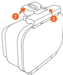
Abra la cubierta exterior en la dirección de la flecha
