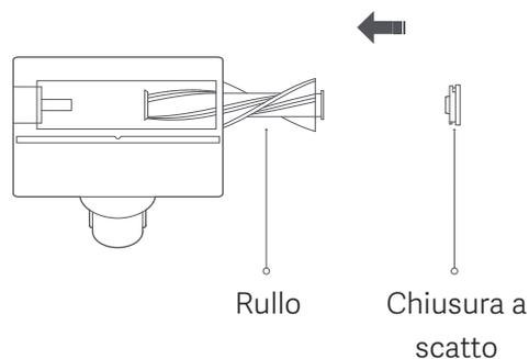
6. Con la chiusura a scatto laterale della testina a spazzola rivolta verso l'utente, utilizzare una moneta per ruotare il meccanismo in senso orario fino alla posizione di blocco, assicurandosi che il rullo sia in posizione.
