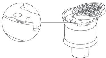
3. Allineare il sistema ciclonico con l'aspirapolvere come mostrato nella figura. Fissare il sistema ciclonico in posizione ruotandolo in senso orario.
