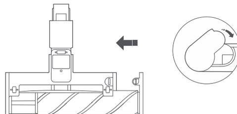
6. Ruotare la chiusura a scatto di 90° in senso orario fino alla posizione di blocco per fissare il rullo.
