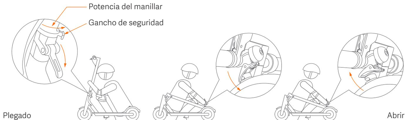
Deberá apagar el patinete antes de plegarlo. Sujete el eje del manillar, gírelo en sentido antihorario para abrir el gancho de seguridad y abra la palanca de liberación rápida.
