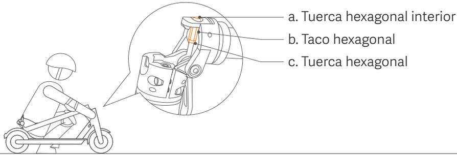
El uso prolongado del patinete podría provocar que los tornillos se aflojen, haciendo que el eje del manillar se vuelva inestable. Si nota que el eje del manillar se tambalea cuando conduce, siga los pasos siguientes.
