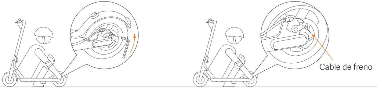
Si el freno está demasiado duro, utilice la llave Allen de 4 mm para aflojar el tornillo del calibrador. A continuación, ajuste ligeramente el cable del freno (disminuya la longitud de exposición) y vuelva a apretar el tornillo.
