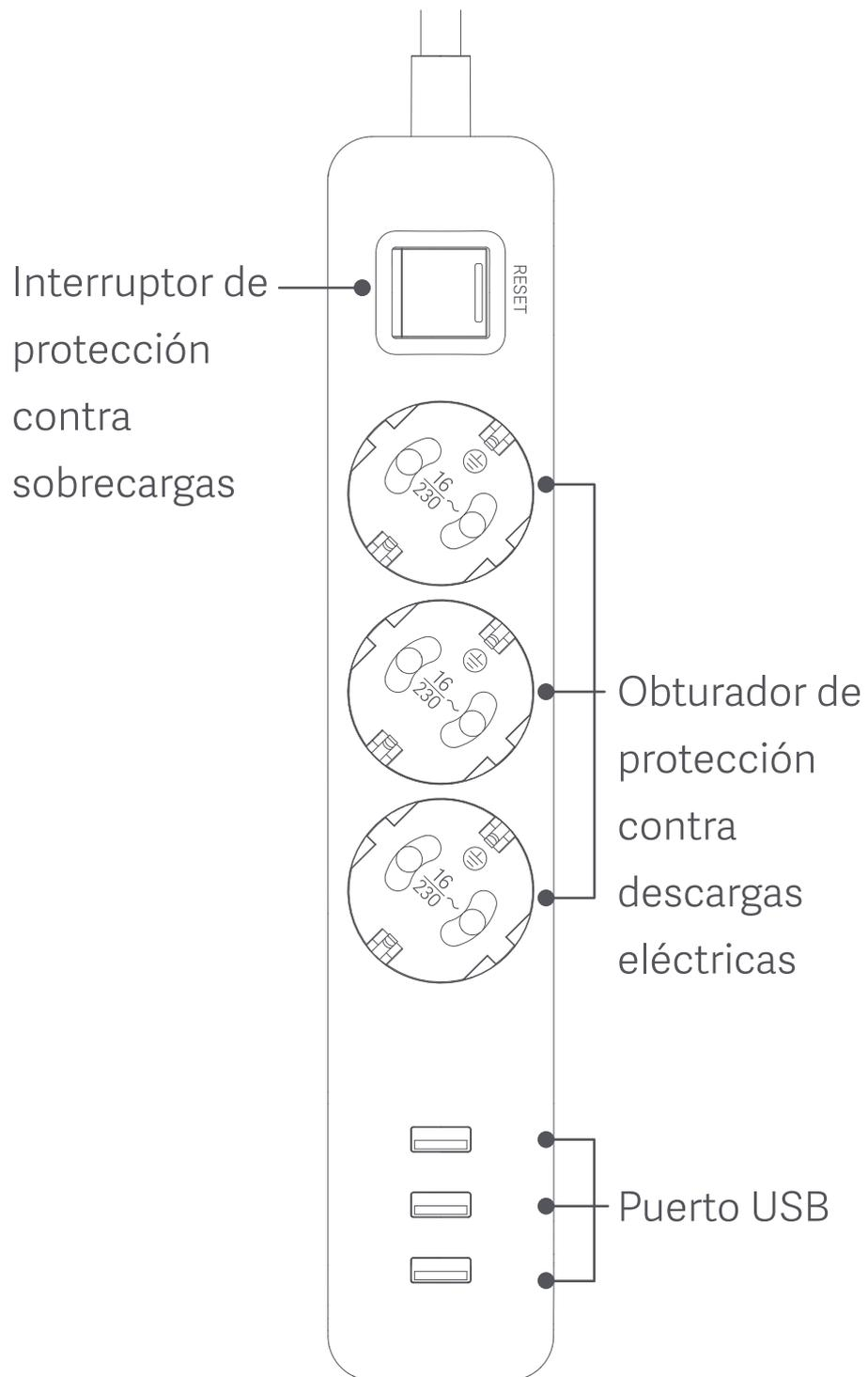
Gracias por usar este producto. Este producto es una regleta con conector con toma de tierra de tres puntos de 16 A y 3 puertos USB. Cuenta con un interruptor de corte dual de protección contra sobrecargas y obturadores de protección eléctrica. También ofrece carga a través de USB (apropiado para cargar equipos de TI).
