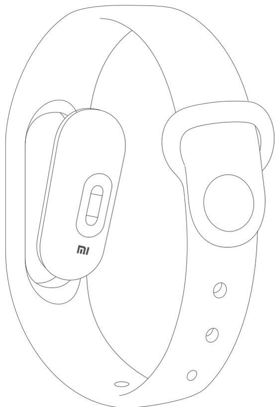
Inserire il sensore dall'interno di Mi Band 2 Strap, come mostrato in figura
