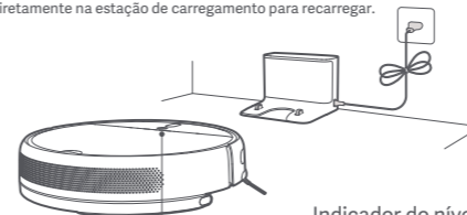
Indicador do nível da bateria Branco: nível da bateria superior a 15% Laranja: nível da bateria inferior a 15%
